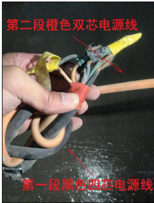
图 5 第一段黑色电源线与第二段 图 6 第二段橙色电源线与第三段 橙色电源线连接处 黄色电源线连接处
