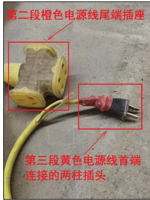
图 5 第一段黑色电源线与第二段 图 6 第二段橙色电源线与第三段 橙色电源线连接处 黄色电源线连接处
